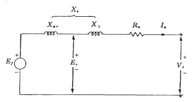
同步電動機的等值電路與發電機的等值電路相同,只需將電流 *I。*所示的方向倒轉即可。
