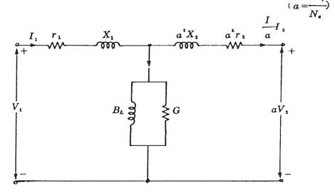
忽略磁化電流,更進一步簡化電路模型,令
