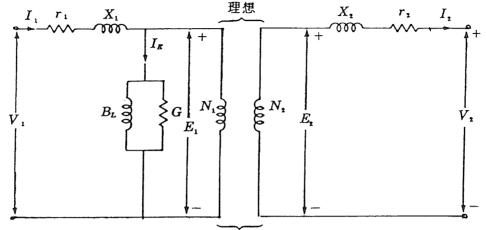
若所有的電量都換算到變壓器之同一側,則變壓器等值電路模型裡之理想變壓器可以省略,因而獲得下圖所示之等值電路模型。  $N_1$
